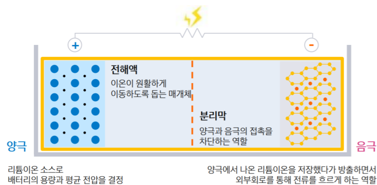
그림 5 리튬이온전지의 내부 구조
